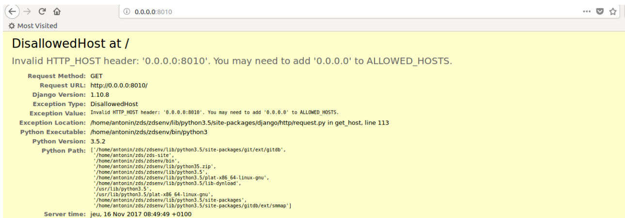
FIGURE 1.1. – Erreur (en mode debug) précisant que l'application n'est pas configurée pour fonctionner sous ce nom d'hôte.
