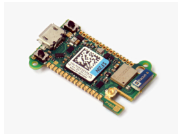
FIGURE 2.3. – pyboard-D, avec connectivité WiFi et Bluetooth.
